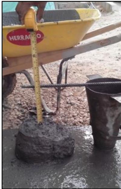
Figura 10. Medición de asentamiento
