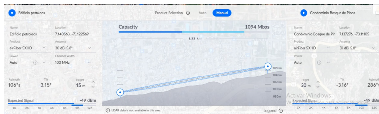
Figura 26: Línea de vista entre el edificio de petróleos y barrio los Pinos con aplicativo web Ubiquiti
