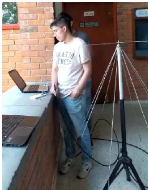
Figura 38: Prueba con antena omnidireccional y antena modulo LoRa Ra-02
