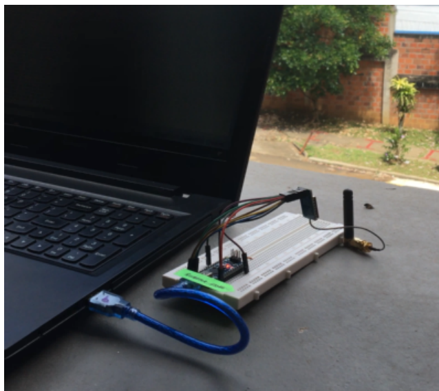
Figura 4: Sistema de transmisión y recepción mediante radios LoRa y su respectiva alimentación. Sistema de Telemetría. (Fuente:[J. Vivas, 2022])
