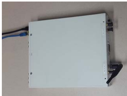
Figura 13. USRP X310 con una antena conectada al puerto RX2.
