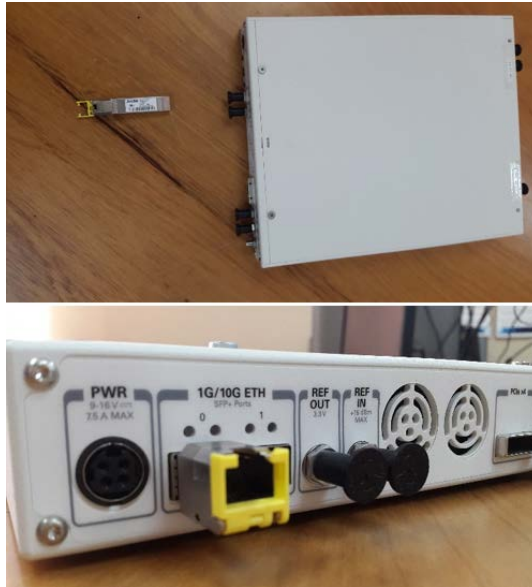
Figura 7. Conexión del adaptador SFP
