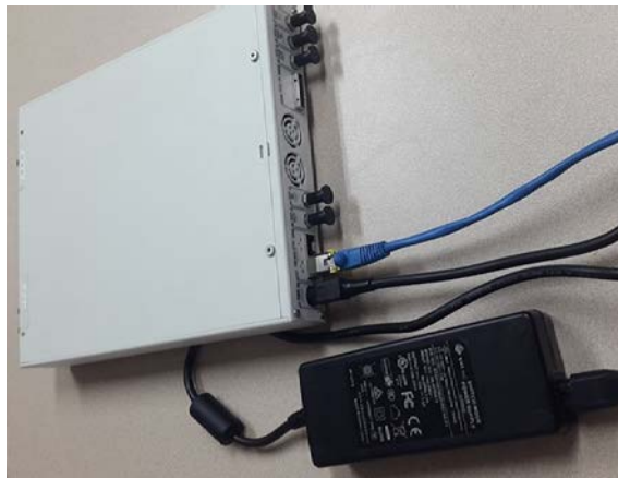
Figura 8. USRP X310 conectado con su fuente de alimentación y al cable Ethernet en el puerto 0.
