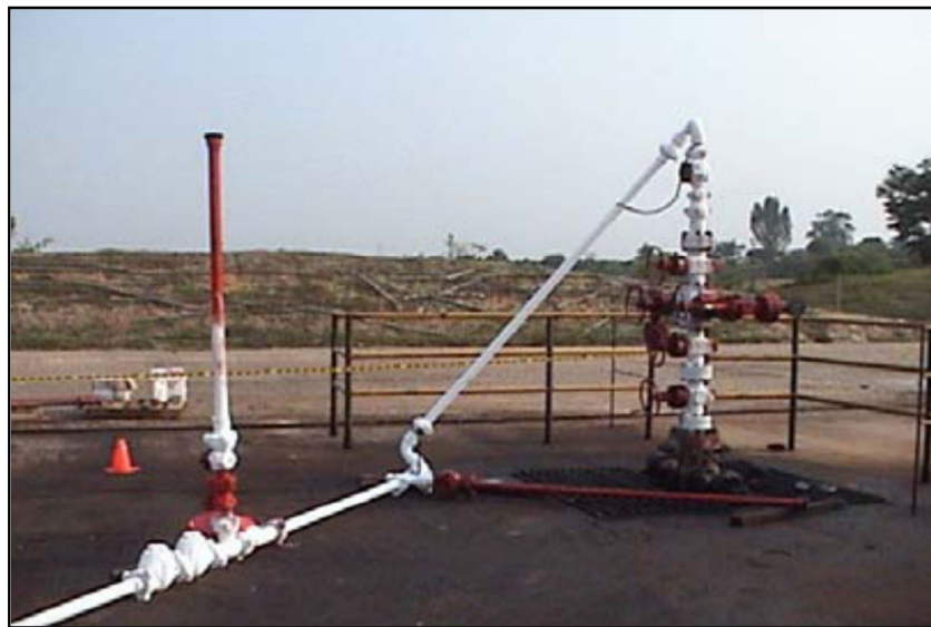
Figura 24. Cold Down o enfriamiento de líneas.
