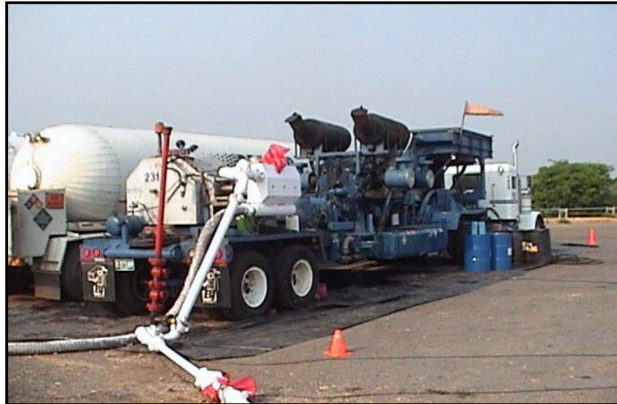
Figura 22. Unidad de Fracturamiento Hidráulico.
