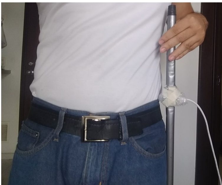
Figura 9: Ubicación de la IMU Xsens a la altura de la cintura sobre una barra para pruebas de adquisición de datos
