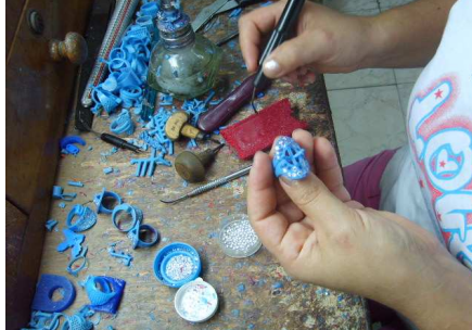
Ilustración 12. Preparar la cera de los modelos a producir
