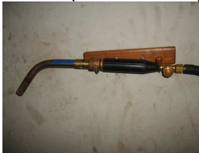
Ilustración 22. Turbo Torch (Pistola de fundir)
