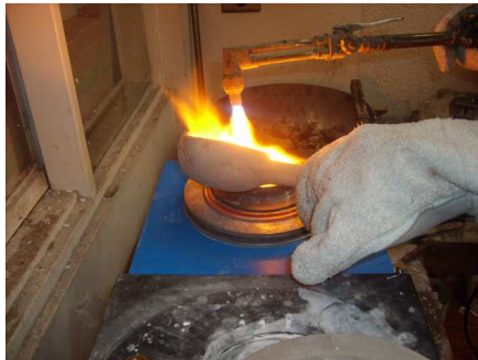
Ilustración 14. Vaciar en bomba de vacío
