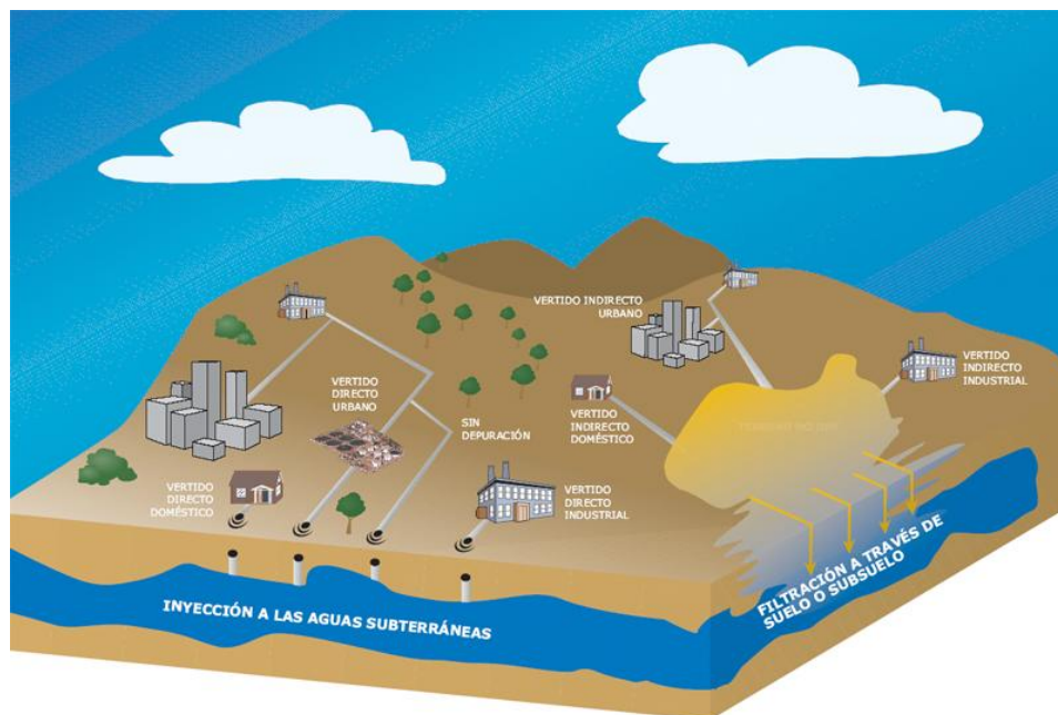
Figura 33. Reinyección de aguas residuales
