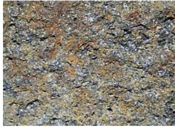
**L.** Corrosión por ácido sulfúrico (Padilla & Guzmán, 2019)
