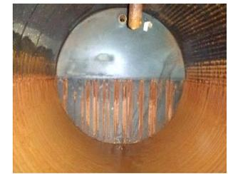
**Ñ.** Corrosion acanalada provocada por estancamiento de agua.
