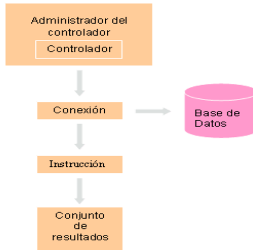
Figura 7. Pasos de las operaciones JDBC básicas
