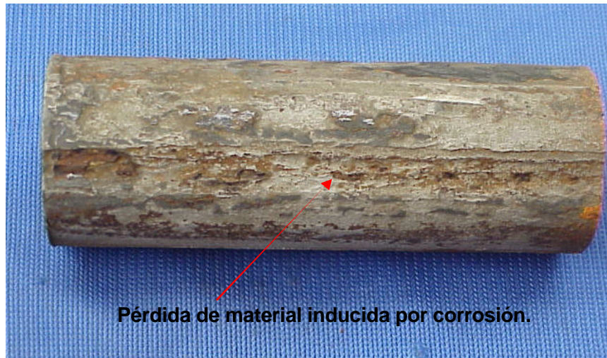
Figura 20. Muestra de acople No 3 de 7/8". Pozo La Cira 1880
