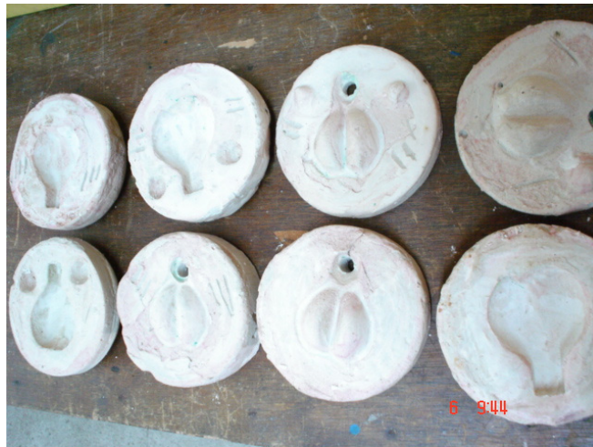
Figura 73: Moldes de los álabes
