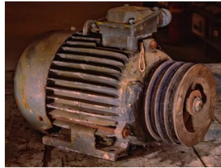
Figura 4 Motor afectado por la corrosión, producto de un deficiente plan de preservación durante el almacenamiento. 1
