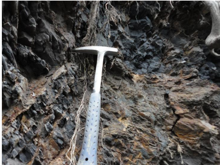
Figura 22. Material muy fracturado con fisilidad, Imagen tomada a 49 m de la base de la Formación Chipaque.
