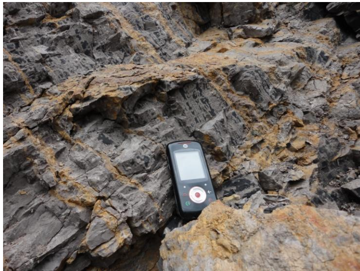
Figura 23. Planos de diaclasamiento lo cual deduce un comportamiento frágil. Imagen tomada a los 74 m de la base de la Formación Chipaque.
