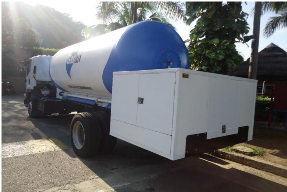
Figura 60. Vista del carrotanque una vez terminado el cajón de protección
