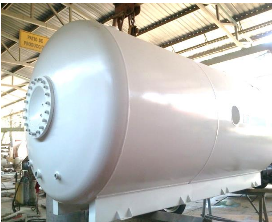
Figura 51. Montaje del tanque sobre el chasis
