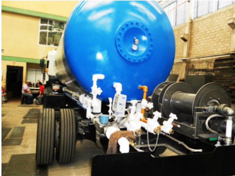
Figura 58. Vista del sistema de trasiego antes de montaje cajón de protección
