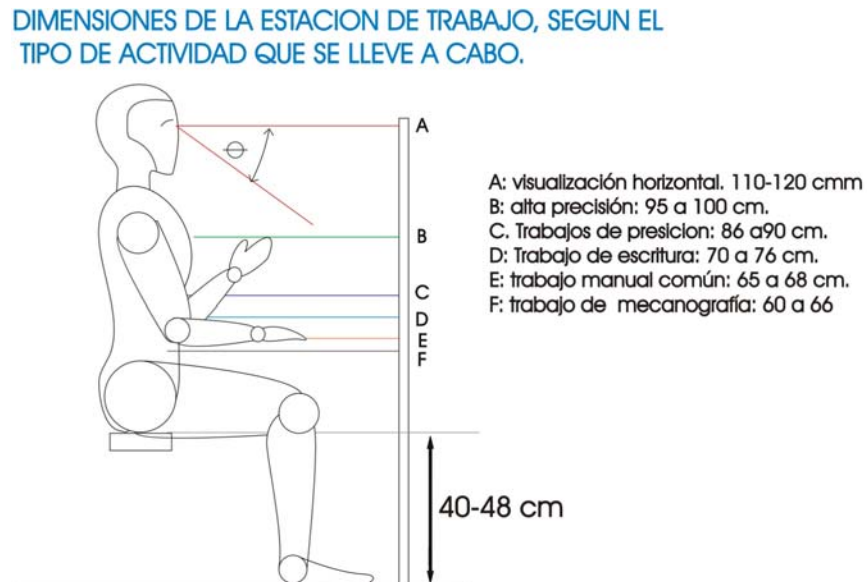
Figura 16. Dimensiones de la estación de trabajo, según el tipo de actividad que se realice.
