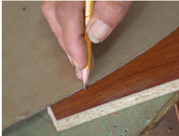
Figura 67. Calcado de las formas a la lámina.
