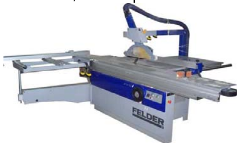
Figura 2. Sierra de disco 5.5. Kw a 3500 rpm. Utilizada para el precorte de la lámina, la línea punteada indica la dirección del corte.
