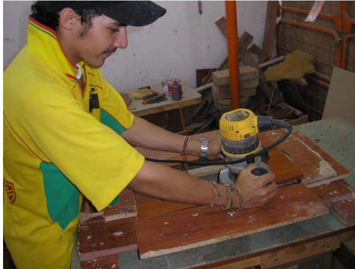
Figura 69. Pulimento de los cantos por medio de la ruteadora.
