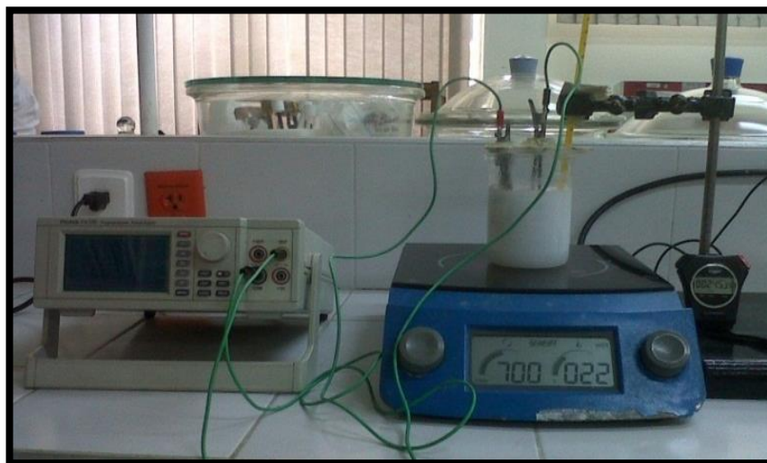
Figura 28. Montaje de la celda electrolítica para electrodeposición de fosfatos de calcio sobre Ti6Al4V ASTM F136.
