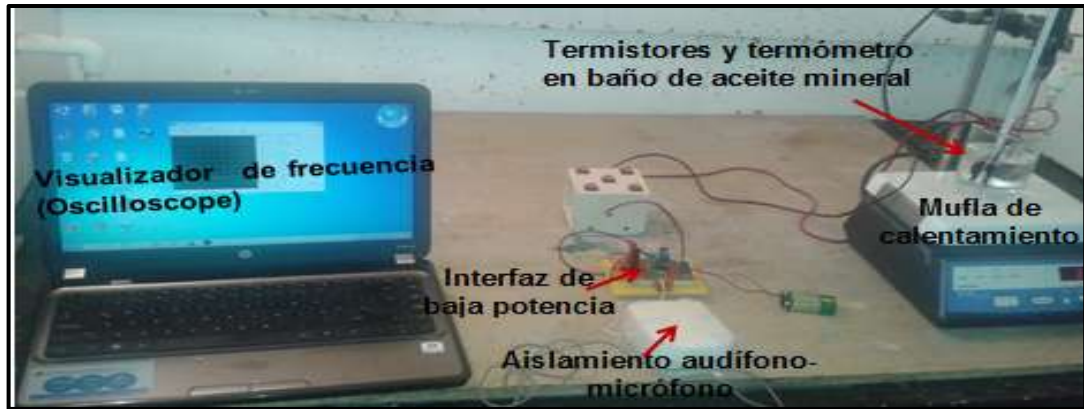
Figura 5. Montaje para medición de los valores de frecuencia durante el calentamiento de los termistores.
