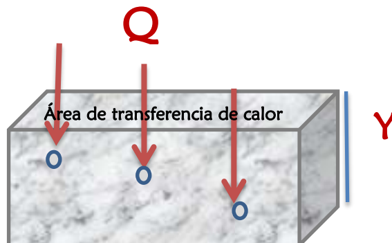
Figura 1. Dirección de la transferencia de calor a través de la muestra.
