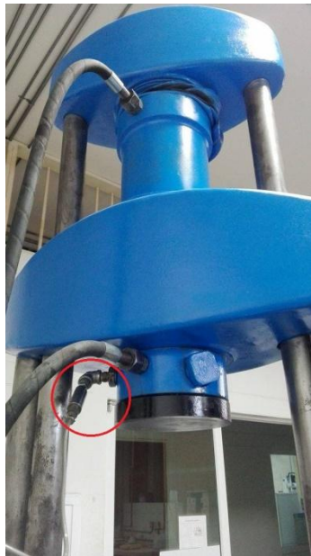
Figura 10. Posición del transductor de presión en la máquina
