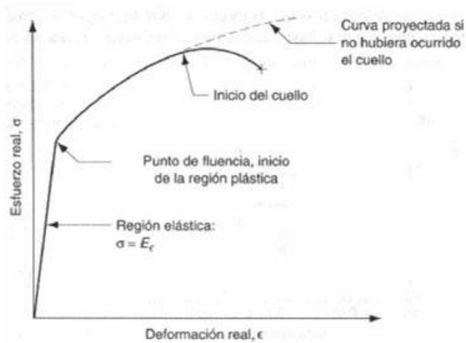
Figura 5. Diagrama esfuerzo real-deformación real
