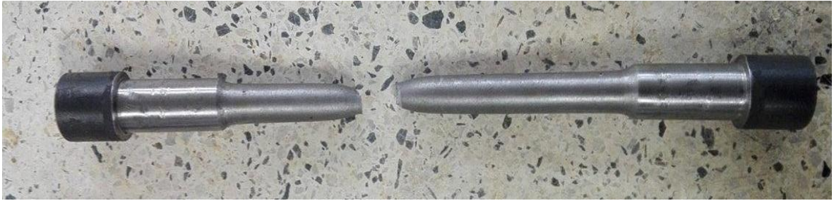
Figura 28. Falla de la probeta de acero estructural.
