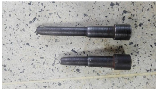
Figura 31. Falla de la probeta de acero 1045
