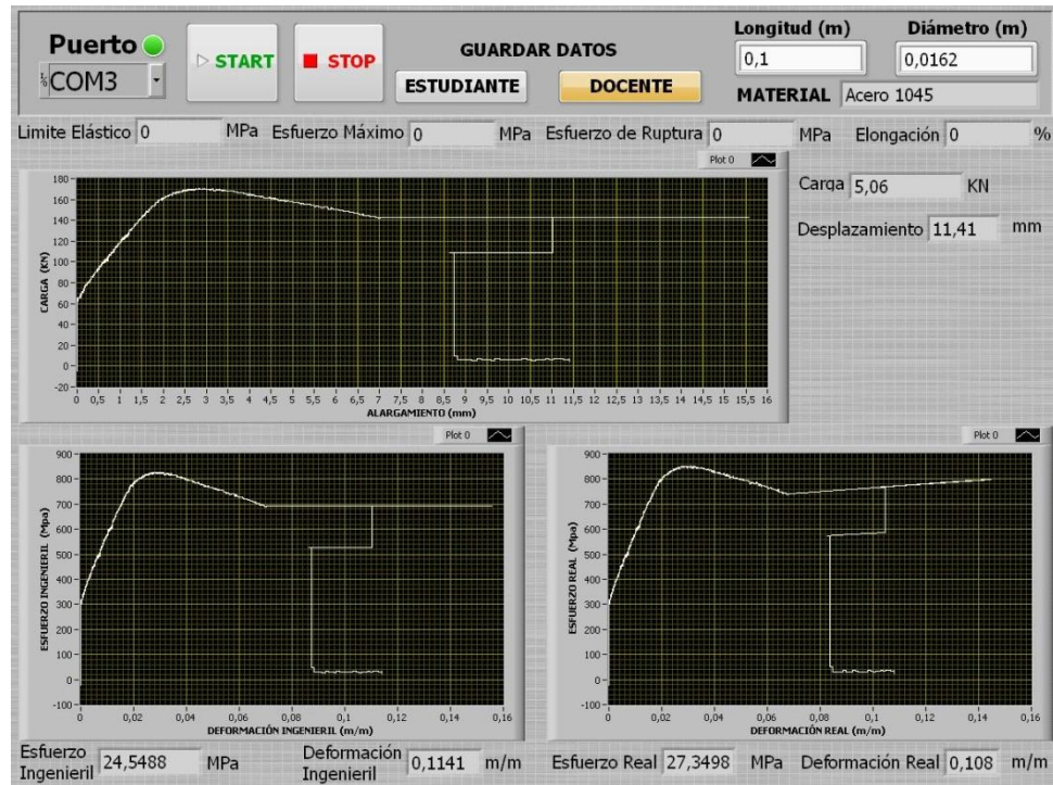
Figura 34. Prueba 3 para acero 1045.
