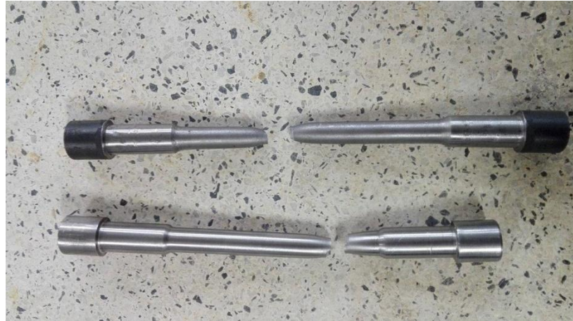
Figura 32. Falla de las probetas ensayadas.
