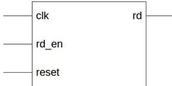
Figura 6.6: esquemático del bloque generador de pulso de lectura
