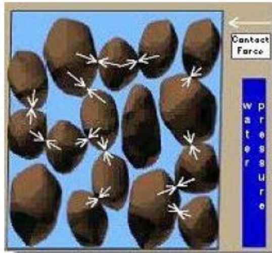
Figura 6- 2 Las fuerzas de contacto disminuyen debido a las altas presiones de agua
