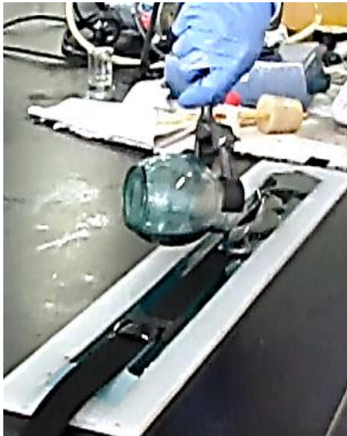
Figura 10. Vaciado de la mezcla polimérica en el molde de silicona.
