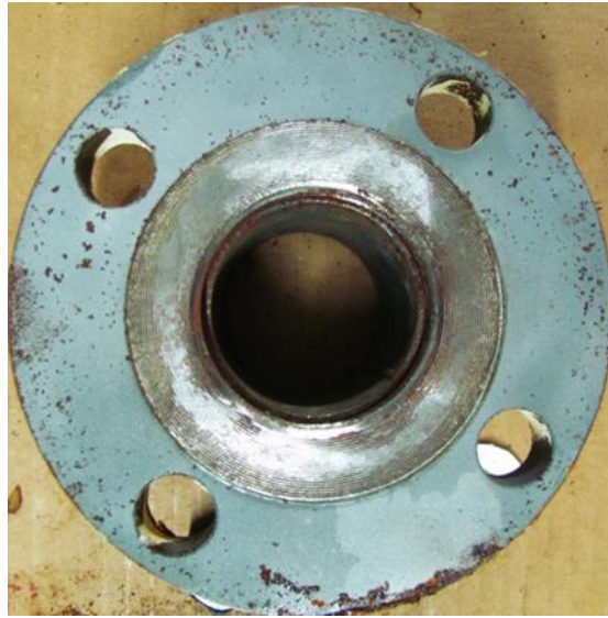
Figura 18. Superficie interna de una brida protegida por el Cast-Urethane.
