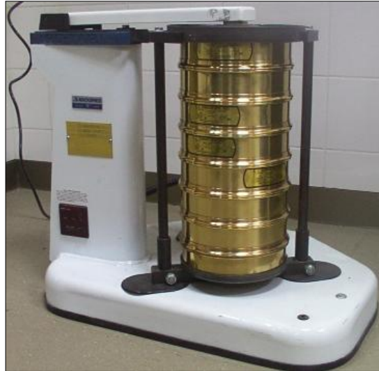
Fotografía 26. Vibrador mecánico del laboratorio de tamizaje de la escuela de Geología UIS
