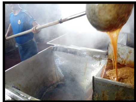
Fotografía 6. Proceso de cocción del jugo de la caña
