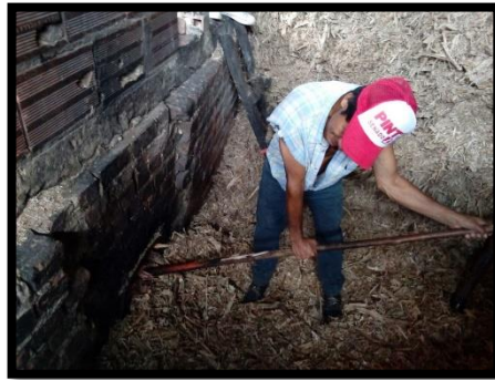
Fotografía 5. Hornillero metiendo el bagazo a la hornilla.
