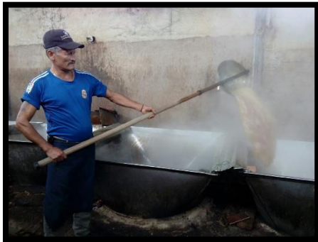
Fotografía 6. Proceso de cocción del jugo de la caña
