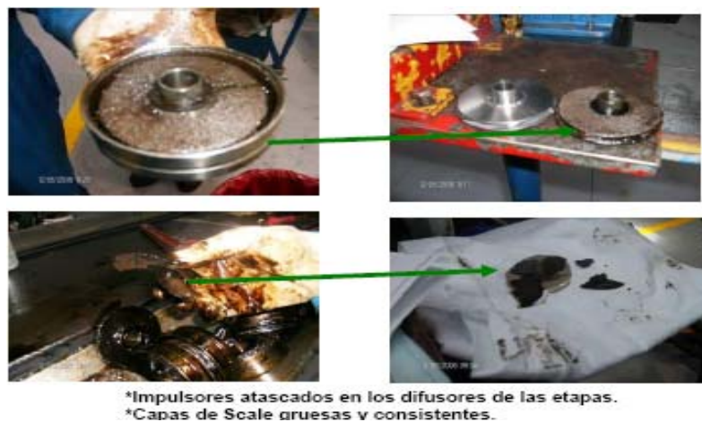
Figura 9. Muestra #2 de incrustación en la bomba de subsuelo Pozo P-1
