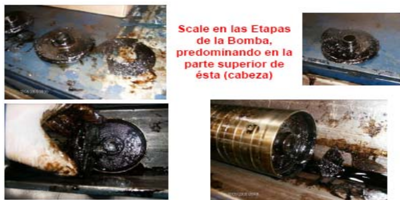
Figura 8. Muestra #1 de incrustación en la bomba de subsuelo Pozo P-1
