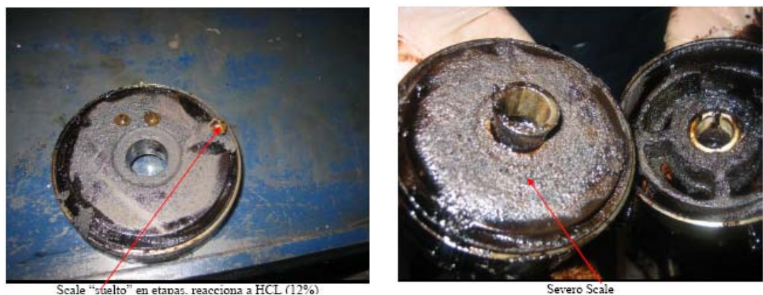
Figura 16. Muestra de incrustación en la bomba de subsuelo Pozo P-3.
