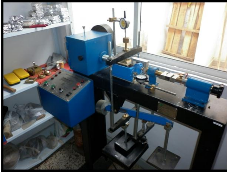
Fotografía N. 12 Ensayo Corte Directo
