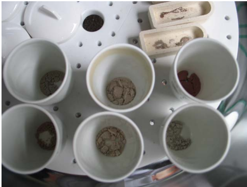
FOTO 3. Resultado de prueba para determinar contenido de cenizas, la coloración indica aquellas muestras que tienen mayor cantidad de Azufre.
