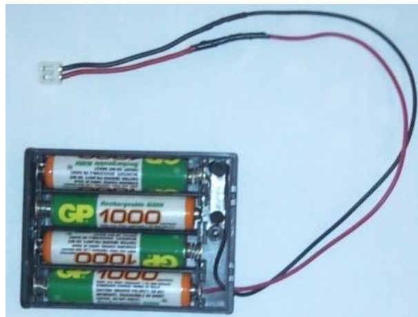
Figura 14. Fuente baterías recargables.
