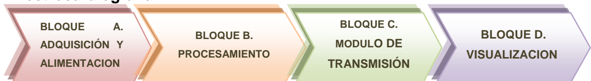
Figura 11. Diagrama de Bloques del Modelo Funcional de Electrocardiografía.
