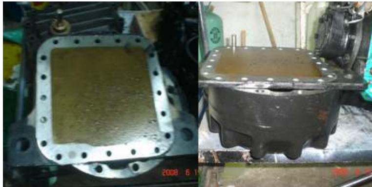
Figura 66. Partículas del aceite contaminado en la tapa del cárter
