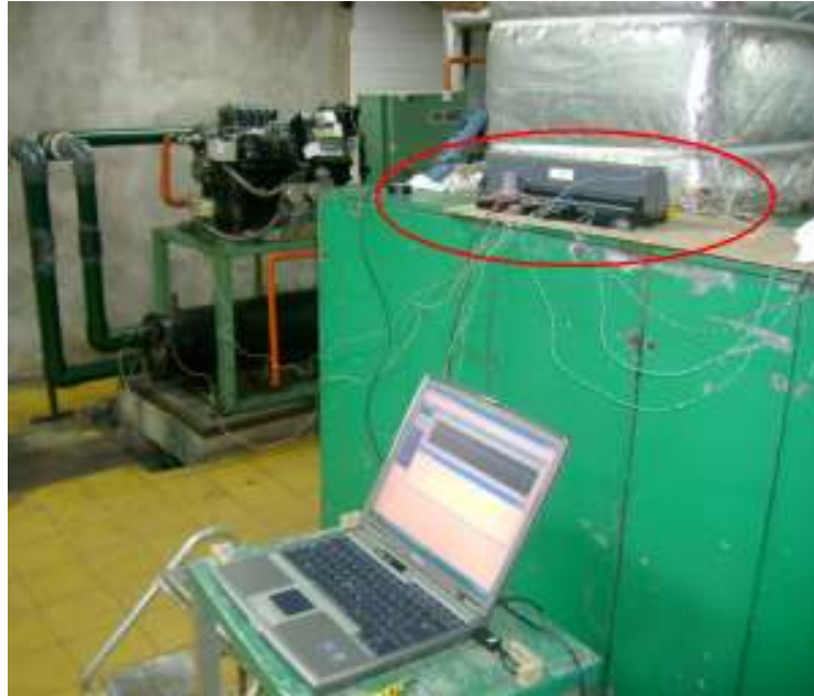
Figura 41. Adquisición de datos en campo utilizando el Fieldpoint
