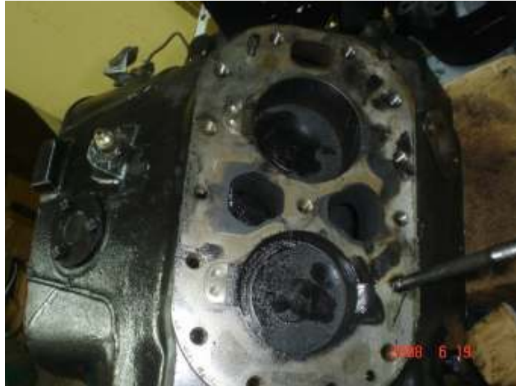
Figura 64. Aceite quemado en los cilindros del compresor
