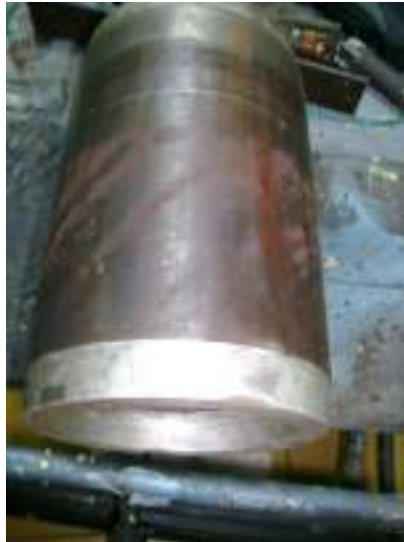
Figura 70. Rotor con marcas de fricción
