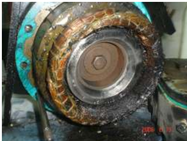
Figura 67. Estator con quema localizada
