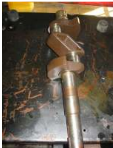
Figura 69. Cigüeñal con marcas de fricción
