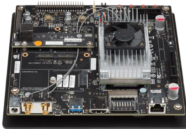
*Nota.* Es la sucesora de la Jetson TK1 con arquitectura Maxwell y 256 CUDA Cores. Imagen tomada de <https://www.amazon.in/NVIDIA-Jetson-TX1-Development-Kit/dp/B017NWO6LG>.
