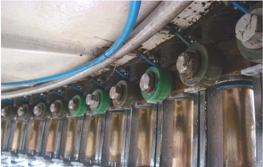
Figura 28. Rodillos Baja Pistones de la Llenadora Carballo
