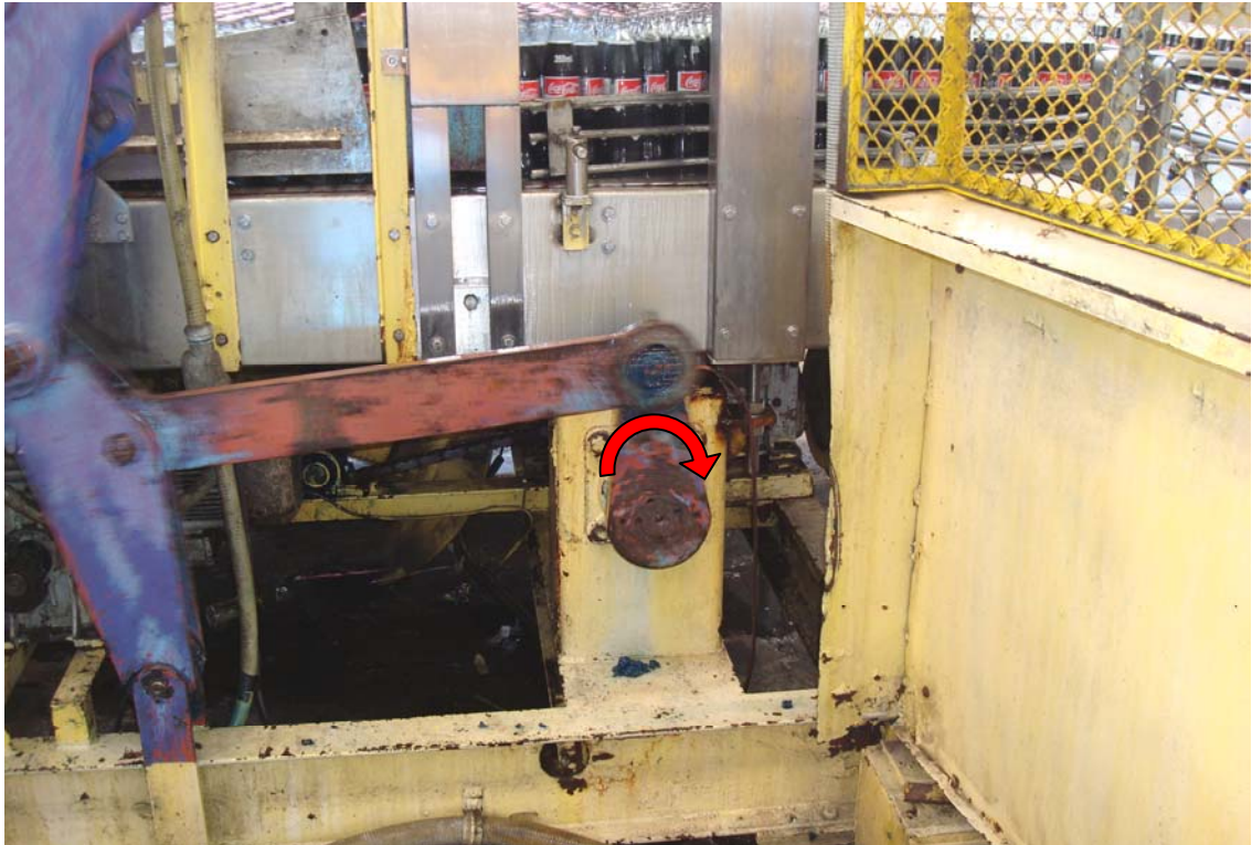
Figura 36. Sentido de Giro del Sistema Biela-Manivela de una Empacadora
