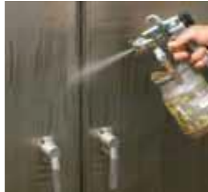
Prueba de Agua atomizada tipo 12
