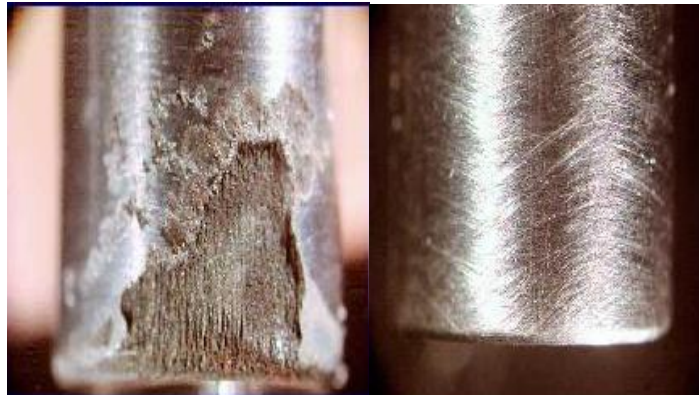
FIGURA 3. EFECTO EN LA TUBERÍA SIN/CON EMPLEO DE INHIBIDOR DE CORROSIÓN.
