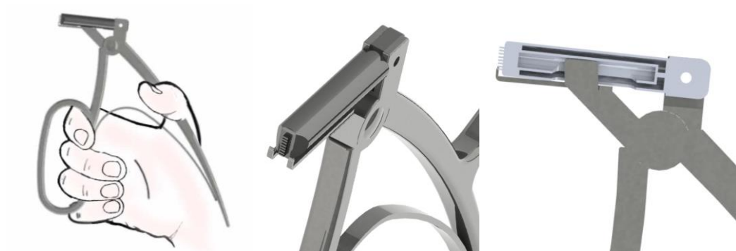
Figura 10 Modelado 1: Herramienta con accionamiento manual para perforar
