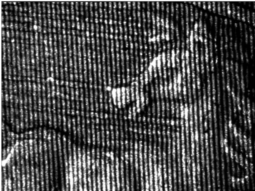
**Figura 25. Sistema de franjas proyectado sobre la superficie de una moneda.**
