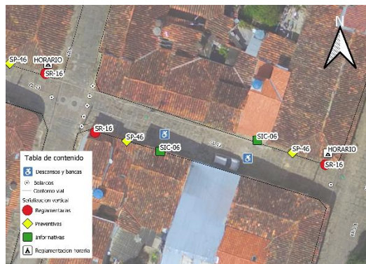
Figura 8. Tipología en planta con peatonalización vial.
