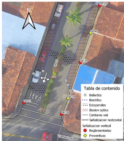
Figura 10. Tipología en planta con tráfico calmado en vía de doble sentido con separador.
