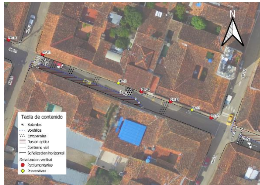
Figura 11. Tipología en planta con tráfico calmado en vía de único sentido
