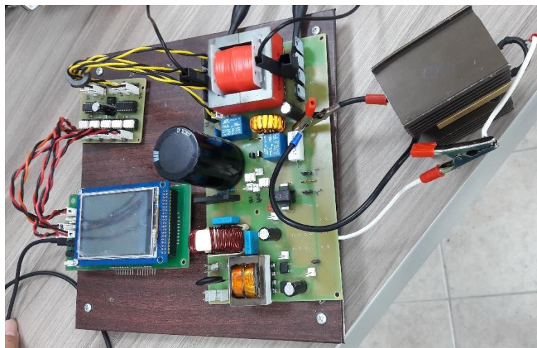
Figura 57. Prototipo de fuente conmutada construido, distinto ángulo.
