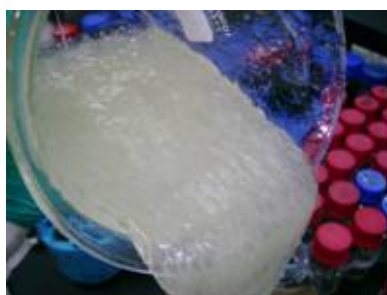
Figura G2. Fluido de Fractura roto o gel roto, después de agregar rompedor puro y someterlo a temperatura
