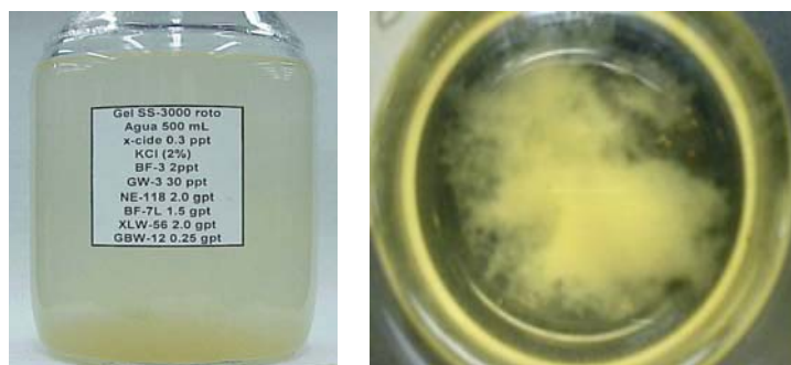
Figura 6. Blanco del fluido de fractura donde se aprecia el sedimento o precipitado flotante que deja el polímero.
