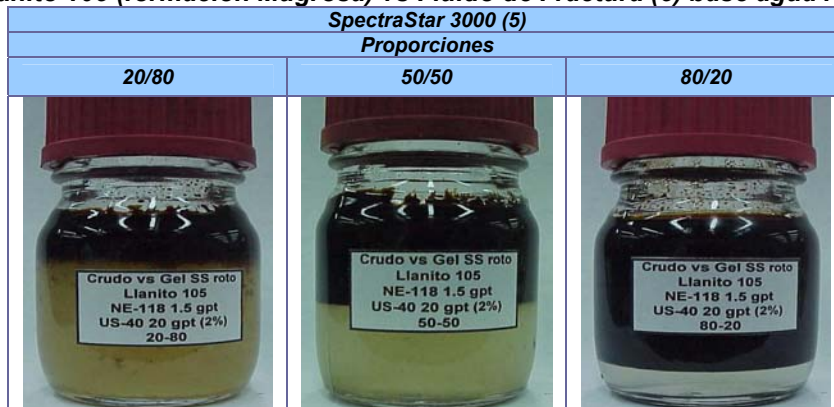
Figura I10. Resultados obtenidos en la prueba de compatibilidad entre el crudo Llanito 105 (formación Mugrosa) vs Fluido de Fractura (5) base agua roto.
