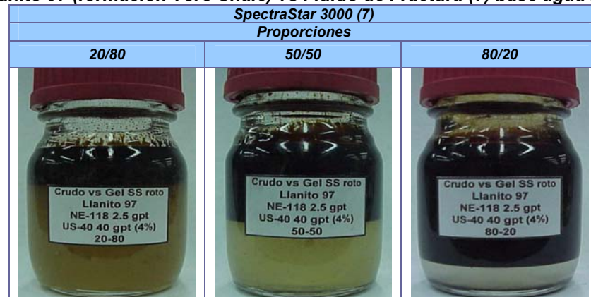
Figura I13. Resultados obtenidos en la prueba de compatibilidad entre el crudo Llanito 97 (formación Toro Shale) vs Fluido de Fractura (7) base agua roto
