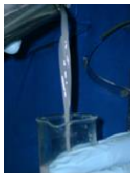
Figura G2. Fluido de Fractura roto o gel roto, después de agregar rompedor puro y someterlo a temperatura
