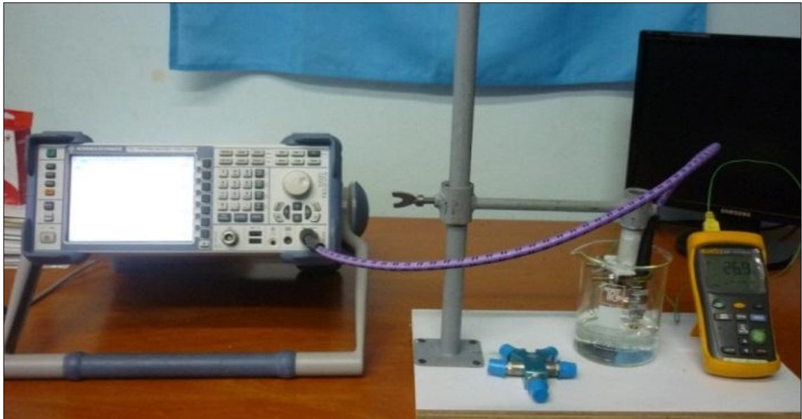
Figura 12. Sistema de medición: Analizador de redes vectorial, sonda de medición y estándar de calibración para el analizador de redes.
