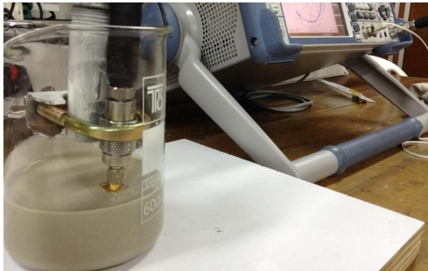
Figura 32. Sonda coaxial abierta en un extremo adjunta a un material bajo prueba (Lodo de perforacion base agua).
