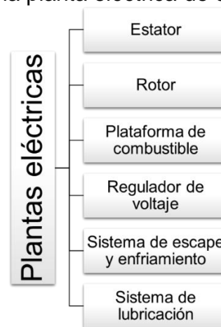
Figura 3. Componentes de una planta eléctrica de emergencia
