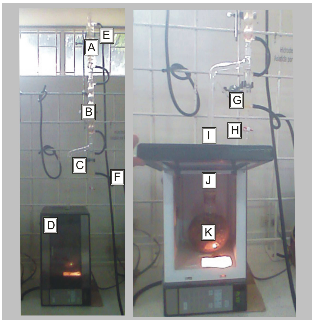
Figura 11. Montaje en el laboratorio para obtención del AE de Salvia aratocensis por MWHD.
