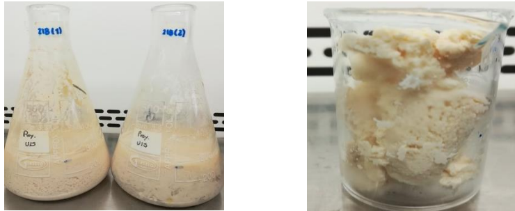
Figura 19. Aspecto final de los caldos de fermentación en las pruebas con lactosuero concentrado para la prueba original y duplicado del medio 2, con L. casei ATCC 393 a 37°C, pH controlado y 130 rpm luego de 42 h y 54 h de fermentación respectivamente.
