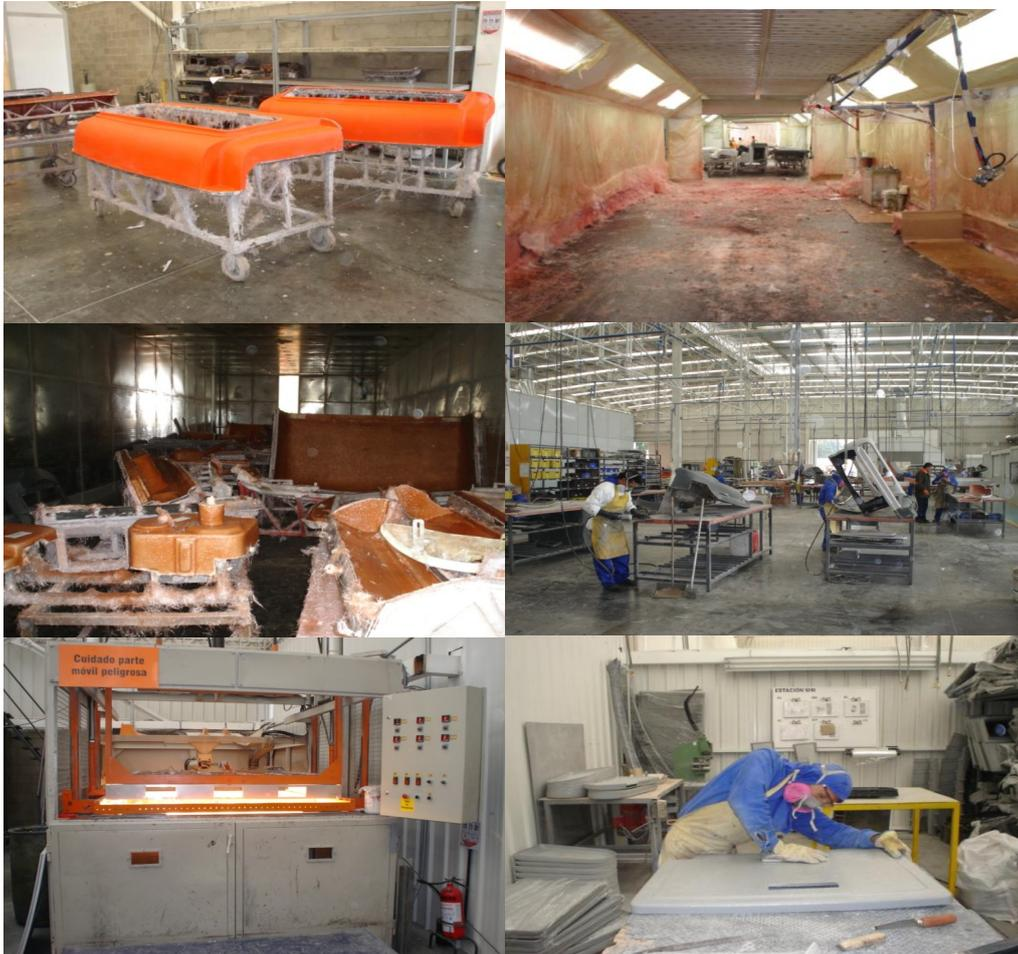
Proceso de Laminación, Aquí se aplica la Resina y la Fibra sobre el molde y luego se lamina la fibra con rodillos para darle forma a la pieza según el molde.
