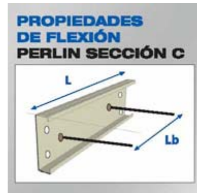
Figura #31: Propiedades Flexión Perlin Z. Figura #32: Propiedades Flexión Perlin C.
