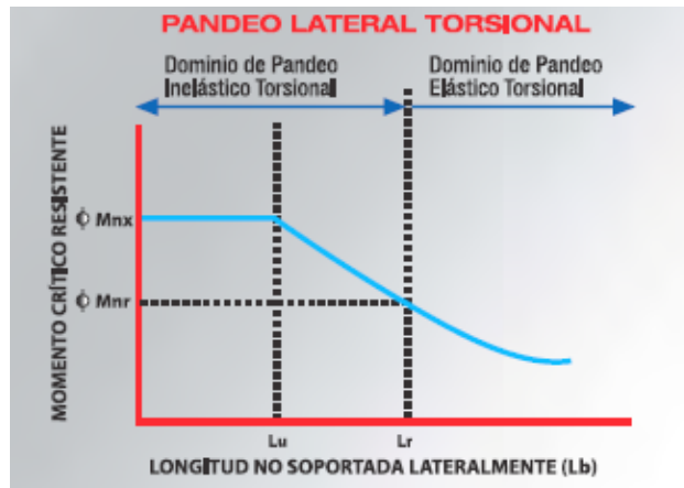
Figura # 30: Grafico Momento Crítico Resistente Vs Longitud no soportada Lateralmente ( L_b ).
