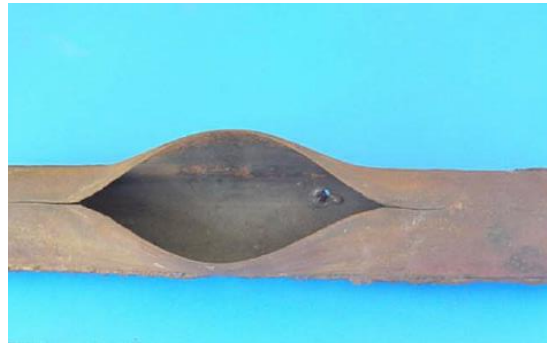
Figura 2. Falla por sobrecalentamiento de corta duración [9].
