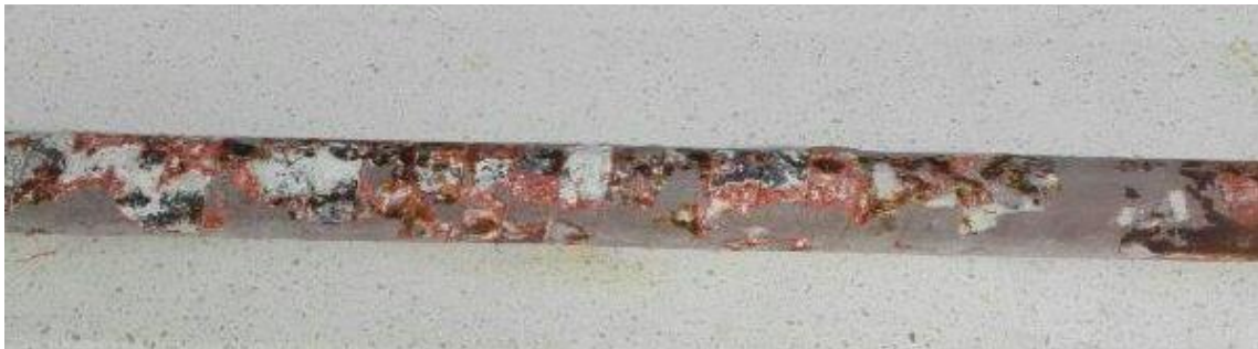
Figura 4. Fotografía del tubo removido de la caldera de Avidensa Mac-pollo con presencia de pigmentos en la superficie.
