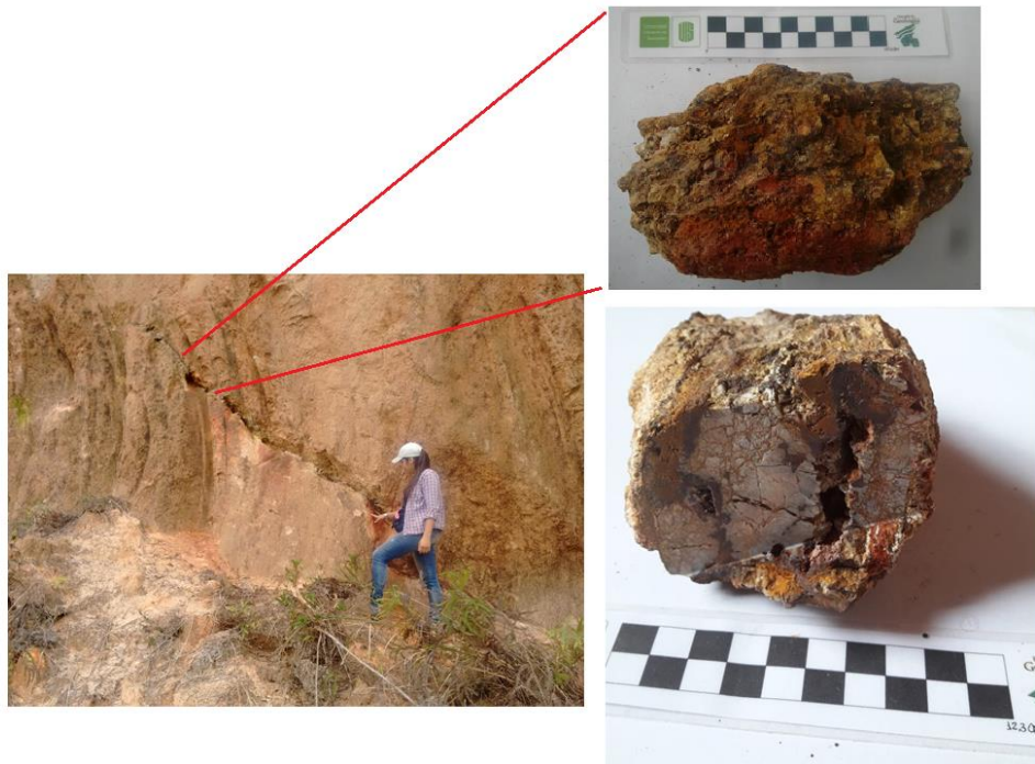
Figura 9. Muestra PKJ 04-04-01, vena de relleno hidrotermal del afloramiento de interés sobre el Batolito de Mogotes. Fotografía tomada por los autores.
