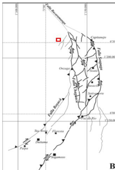
Figura 6. Imagen en la que se muestra el área de estudio aproximada, mediante un rectángulo rojo, en relación a las fallas que hacen parte de la estructura dúplex. Tomado de Velandia, 2005.
