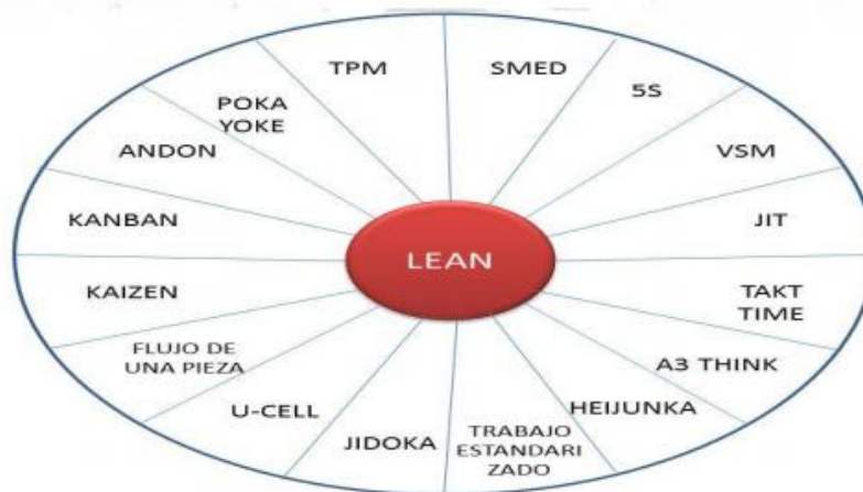
Figura 4. Técnicas y Herramientas para implementar el Lean Manufacturing. Adaptado de Vilana (2011) y Manechote et al (2010) citados por a Betancurth (2013).
