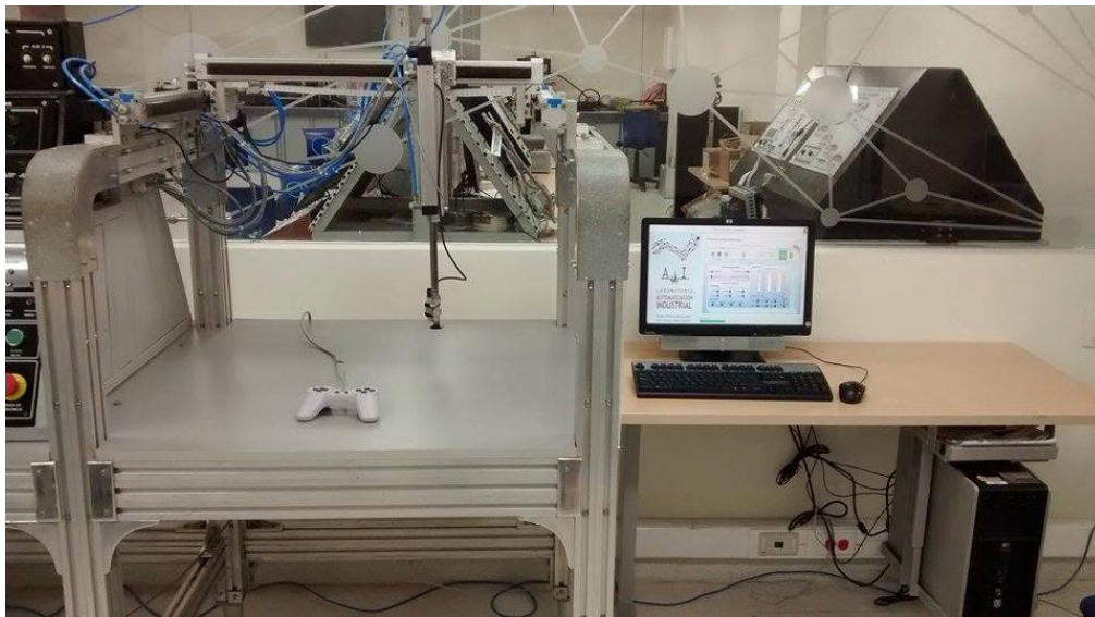
Figura 44. Robot neumático cartesiano sistema final
