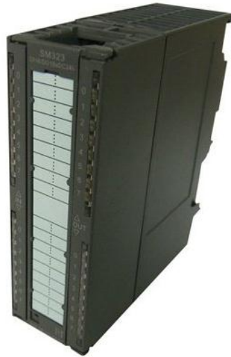
Figura 107. Módulo de 16 entradas y 16 salidas digitales
