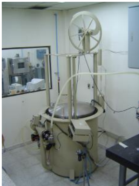
Figura 85 Campana gasométrica CDT de GAS
