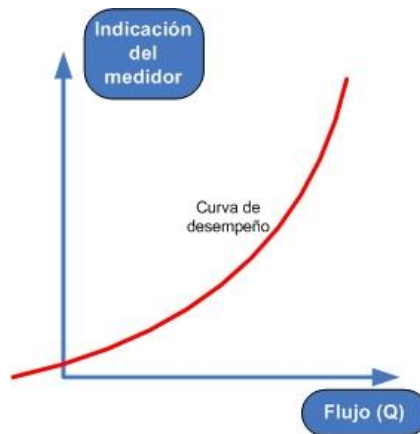
Figura A.7 Curva característica de un medidor tipo no lineal
