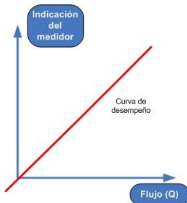
Figura A.6 Curva característica de un medidor tipo lineal
