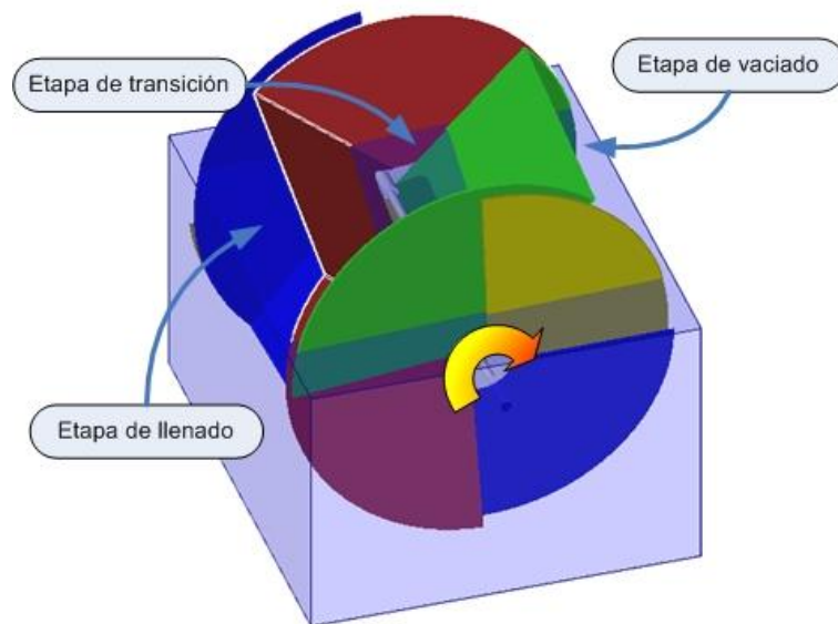
Figura 21 Etapas de una cámara de medición
