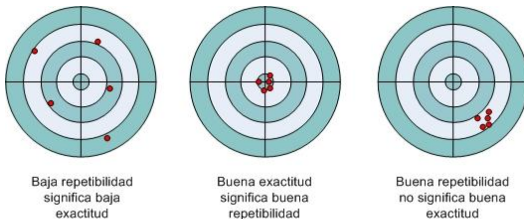
Figura B.2 Diferencia entre exactitud y repetibilidad
