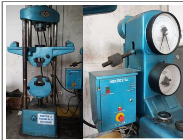
FIGURA 5. MÁQUINA UNIVERSAL DE ENSAYOS MARCA TREBEL
