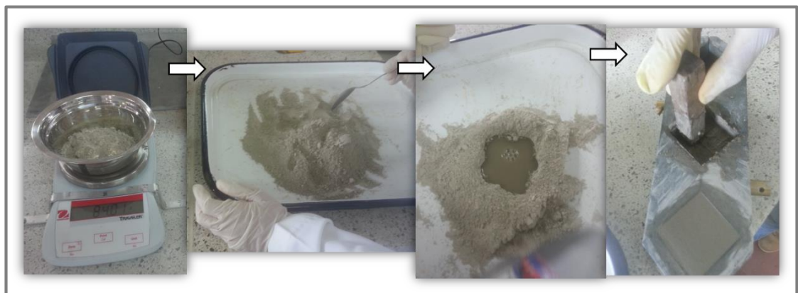
FIGURA 6. PROCEDIMIENTO PARA ELABORACIÓN DE PROBETAS RELAVE-CEMENTO
