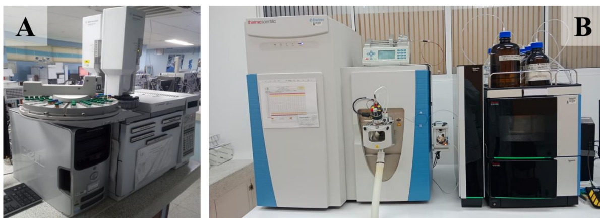
Figura 11. Equipos analíticos instrumentales usados en el estudio. A. GC-MS. B. UHPLC-ESI-HRMS-Q-Orbitrap.
